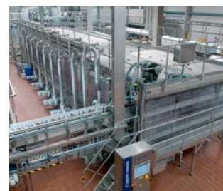
Mit optimaler Isolierung soll die Wärmeabgabe des Pasteurs an die Umgebung weiter reduziert werden.
