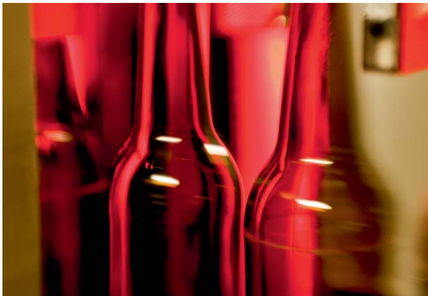
Die Linatronic EBI von KRONES untersucht leere Flaschen aus Glas und PET auf Beschädigungen und Verunreinigungen.
