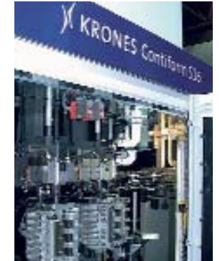
In Hochgeschwindigkeit und auf höchstem technologischen Niveau produzieren die leistungsgesteigerten Streckblasmaschinen der Serie Contiform S bis zu 44.800 PET-Flaschen in der Stunde. Das sind mehr als 14 Flaschen pro Sekunde.
