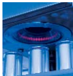
Die Cantronic D überprüft bis zu 120.000 Getränke- oder Konservendosen in der Stunde auf Verschmutzungen und Rillen.
