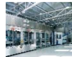
Die Contiform S14 ist die meistverkaufte Streckblasmaschine von KRONES.
