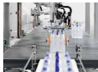
Der KRONES Robobox verteilt Einweggebinde schnell und sicher.
