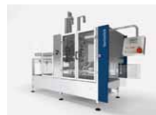
Mit dem KRONES Variostick werden Tragegriffe auf Schrumpfbünde angebracht.
