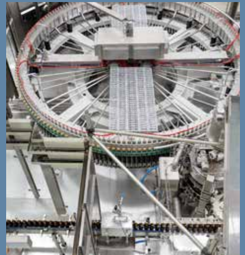
Füller Mecafill VKP-V mit 176 Füllventilen
