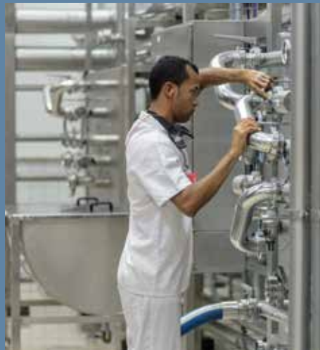
Eine CIP-Anlage mit elf verschiedenen Tanks sorgt für die automatische Reinigung des gesamten Kaltbereichs.
