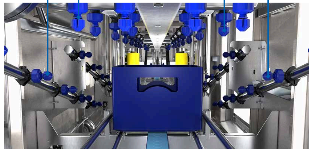
喷淋区和包装箱导向装置
