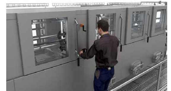
Die Führung kann man sowohl in der Höhe als auch in der Breite bequem von außen einstellen.
