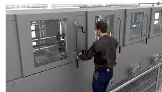
可以从外部方便地调整导向装置的高度和宽度。
