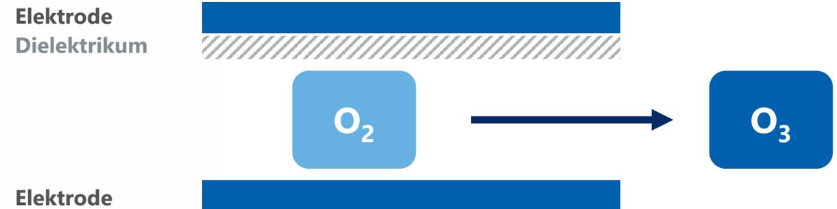
Dieses Ozon wird dann vor dem Füllen dem Trinkwasser zudosiert. Die typische Dosierung liegt bei 0,4 mg/l Wasser.
