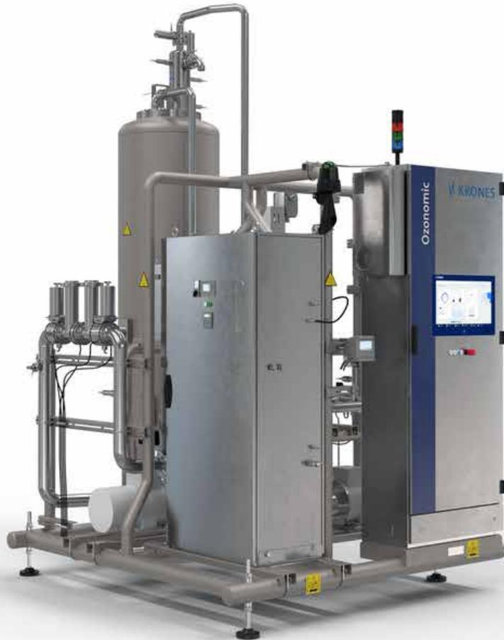
Die Ozonomic arbeitet nach dem Prinzip der „stillen elektrischen Entladung“. Dabei fließt Sauerstoff durch das Modul des Ozon-Generators. Die dort enthaltenen Hochspannungselektroden geben elektrische Energie ab, die dafür sorgt, dass Sauerstoffmoleküle ( $O_2$ ) gespalten und Ozonmoleküle ( $O_3$ ) gebildet werden.
