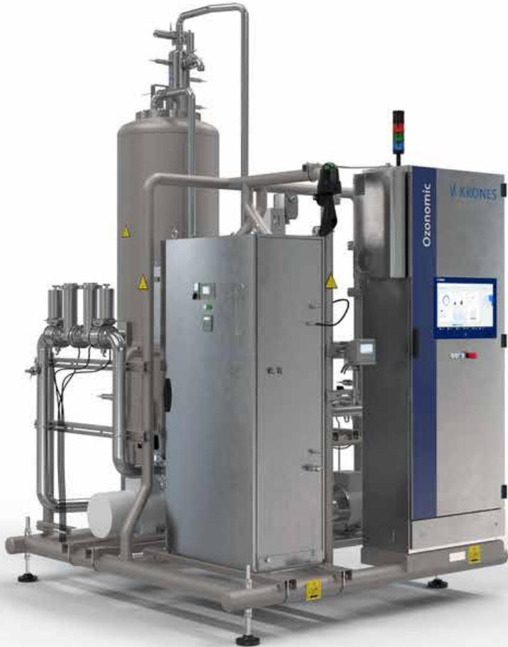
El sistema Ozonomic trabaja según el principio de la "descarga de barrera dieléctrica". Para ello el oxígeno fluye a través del módulo del generador de ozono. Los electrodos de alta tensión allí contenidos sueltan energía eléctrica que se encarga de que se disocian las moléculas de oxígeno ( $O_2$ ) y que se formen moléculas de ozono ( $O_3$ ).
