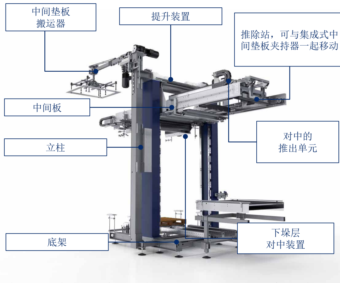
含移动式推除站和下方容器推出装置的 Pressant Universal 1N 容器推除器
