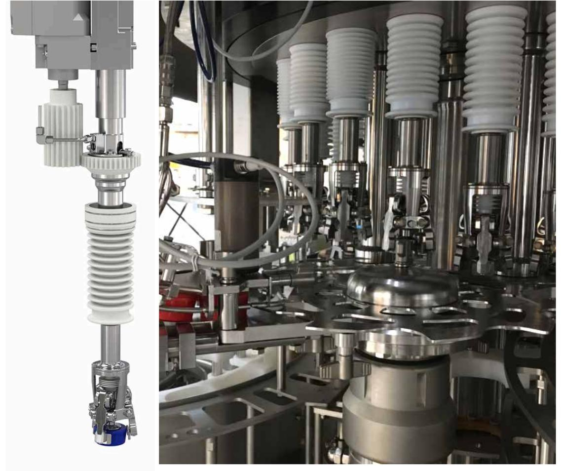
\* G: Grippers (elementos de agarre), S: Servomotor
