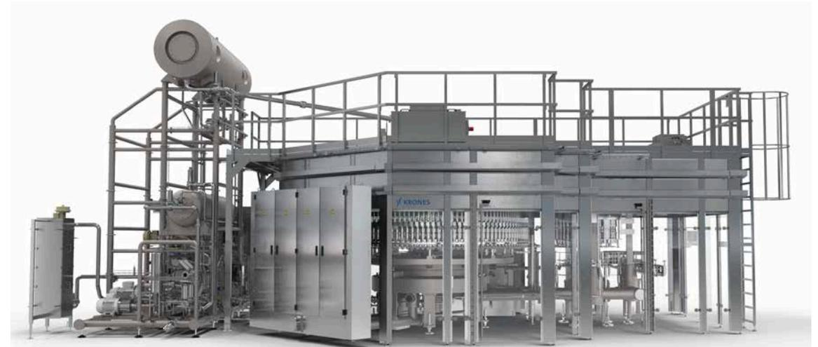
Beim Modulfill VFS-M steht das „M“ für „Mixer“ – Denn dieser ist direkt an den Füller angebunden. So gelangt das Produkt über den erhöhten Karbonisierbehälter unmittelbar in den Verteiler – Und der herkömmliche Füllerkessel kann dadurch entfallen. Dank optimierter Schnittstellen verringert sich auch die Anzahl an Komponenten – Und damit reduziert sich nicht nur der Footprint, auch die laufenden Betriebskosten werden geringer.
