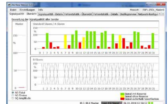
AS-i Messung einer 10 Jahre alten Anlage
