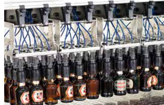
Cabezal de agarre rígido para la extracción de botellas de vidrio de embalajes retornables
