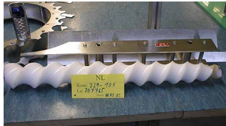
Einteilschnecke mit Führung
