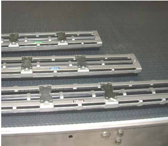
Klemmplatten für Greifeinheit bei Robobox und Tripod
