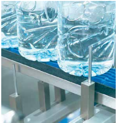
Formatleisten mit Einteilfinger für unterschiedliche Verpackungen
