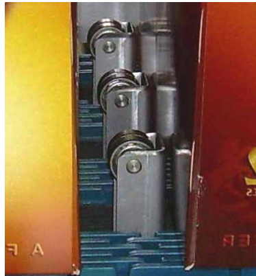
Formatleisten mit Einteilfinger für unterschiedliche Verpackungen
