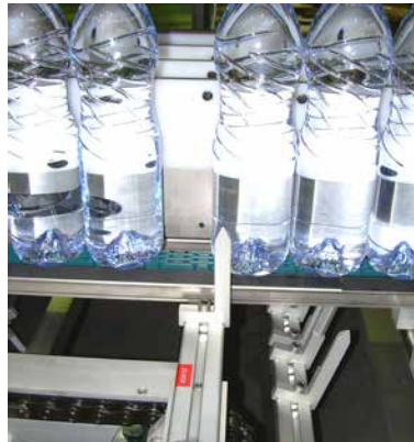
Formatleisten mit Einteilfinger für unterschiedliche Verpackungen
