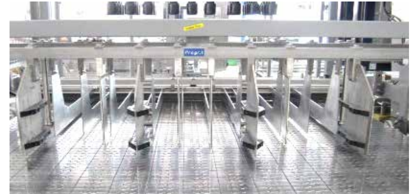
Greiferkopf-Garnitur (Einpacker) mit Einführrahmen, Flaschenleitblechen und Rüttlerbalken
