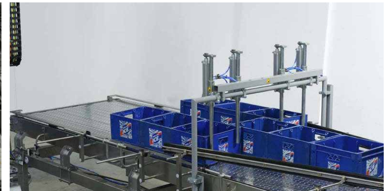
Stopperbrücke zum Entladen
