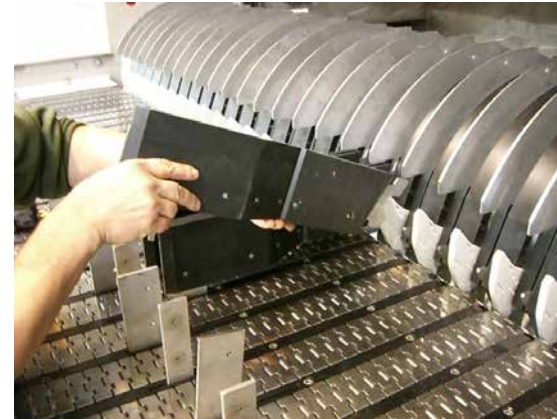
Einfacher Austausch der Flaschenführungen bei einem Produktwechsel
