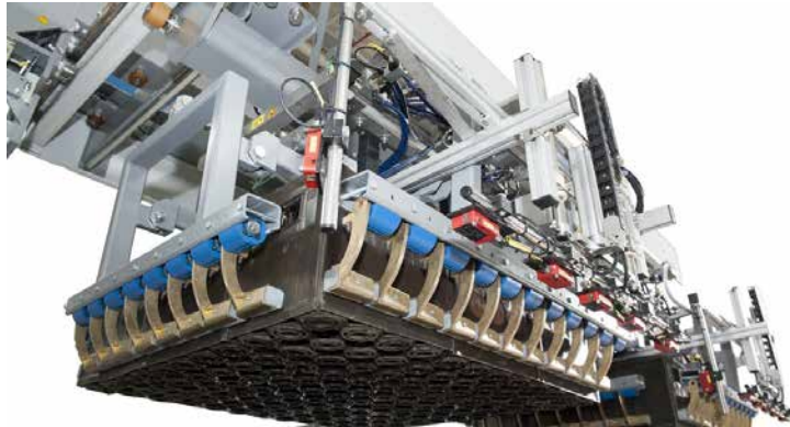
Klemmgreiferkopf zum Beladen (oder Entladen)
